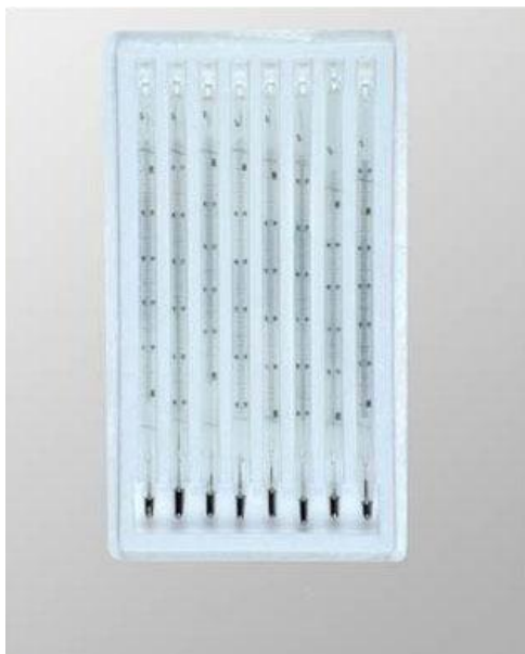
Рисунок 1 - Общий вид термометров ртутных стеклянных лабораторных типа ТЛ-6М
